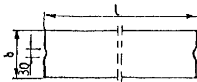
Rys. 1. Wymiarowanie krawężników
